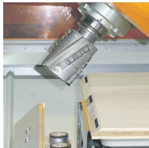
Präzise Fräsungen mit dem topmodernem 5-Achs-Bohr-Fräszentrum.
